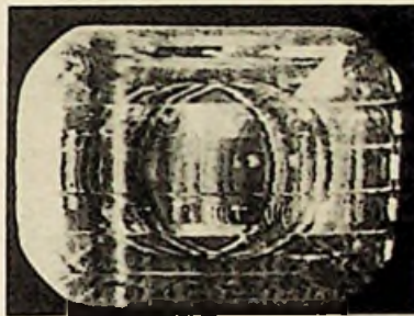
Bild 2. Mit einer handelsüblichen Dipolantenne empfangenes Fernseh-Testbild C mit sehr starken Reflexionsverzerrungen („Geistern“)
