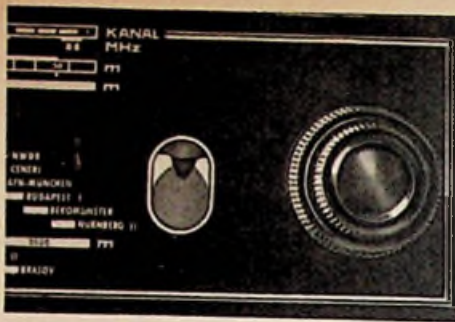
Bild 5. Die EM 85 hinter einer Skala eingebaut
