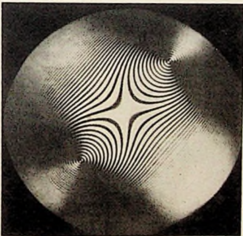
Konoskop-Aufnahme eines bei der ELAC gezüchteten Seignette-Salz-Kristalles
