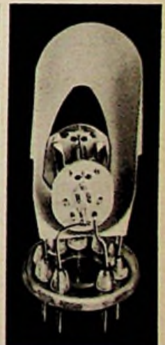
Bild 3. System-Aufbau der EM 85 nach Abnahme der Triodenkappe
